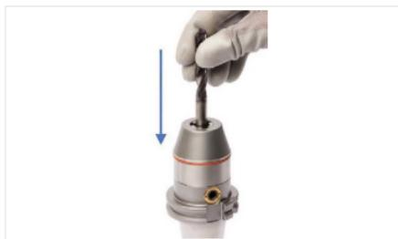
Abb. 3: Werkzeug einschieben
