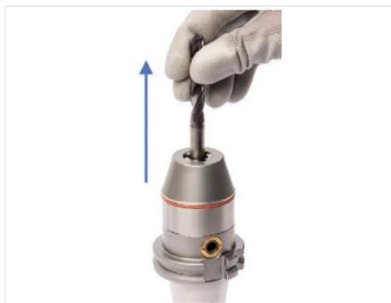
Abb. 6: Werkzeug entnehmen
