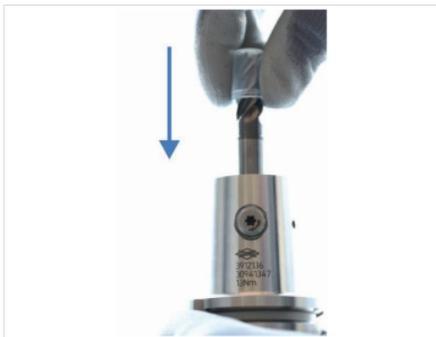
Abb. 3: Werkzeug einschieben
