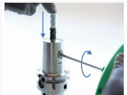
Abb. 4: Werkzeug andrücken und Spannschraube anziehen
