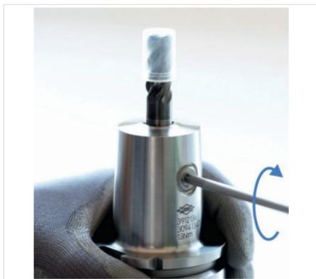
Abb. 5: Spannschraube mit Anzugsdrehmoment anziehen
