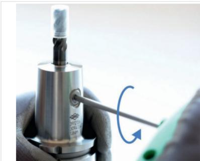
Abb. 6: Spannschraube lösen
