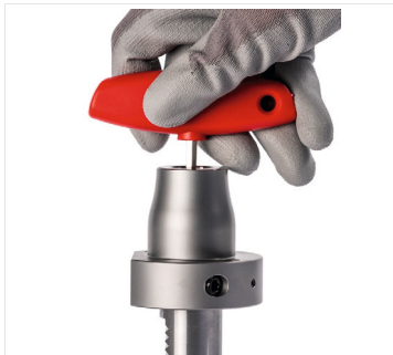
Abb. 8: Werkzeuglänge einstellen (axial)
