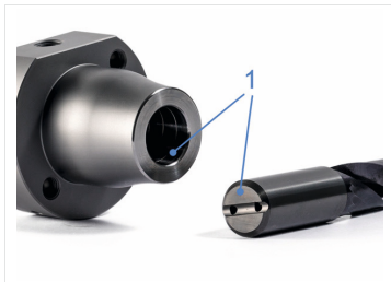
Abb. 7: Dehnspannfutter und Werkzeug reinigen
