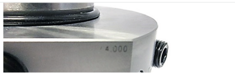
Abb. 5: Beschriftung zur Prüfung der Spannkraft
