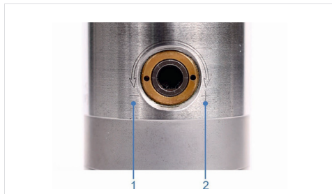
Abb. 3: Drehrichtungsangabe zum Lösen und Spannen des Werkzeugs
