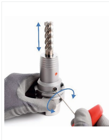
Abb. 11: Werkzeuglänge einstellen (radial)
