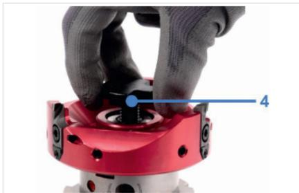
4. Drehen Sie die Fräseranzugsschraube (4) von Hand in die Aufnahmebohrung des Hydrodehnspanndorns ein.
