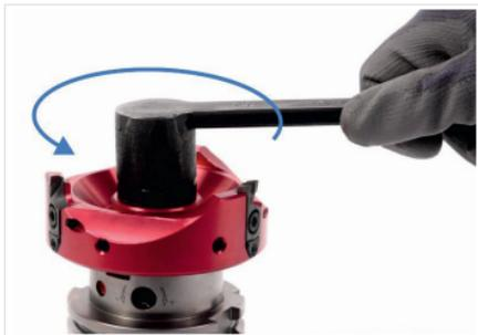
Abb. 8: Fräseranzugsschraube lösen
