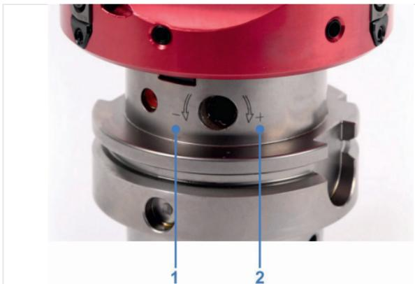
Abb. 2: Drehrichtungsangabe zum Lösen und Spannen des Werkzeugs
