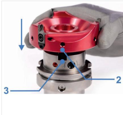
Abb. 4: Werkzeug aufsetzen
