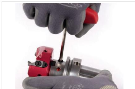
Abb. 9: Spannschraube lösen
