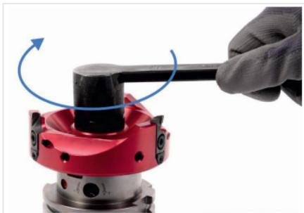
Abb. 7: Fräseranzugsschraube anziehen
