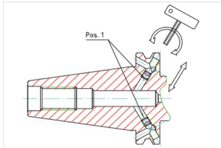
Abb. 14: Grundeinstellung der Kühlmittelzuführung
