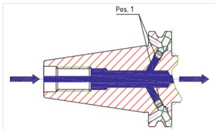
Abb. 16: Kühlmittelzuführung **Form AD/JD**
