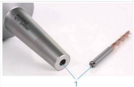
Abb. 8: Dehnspannfutter und Werkzeug reinigen
