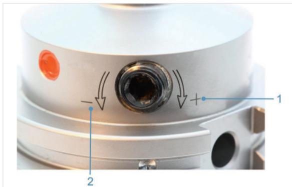
Abb. 7: Drehrichtungsangabe zum Lösen und Spannen des Werkzeugs
