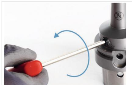
Abb. 12: Spanschraube lösen
