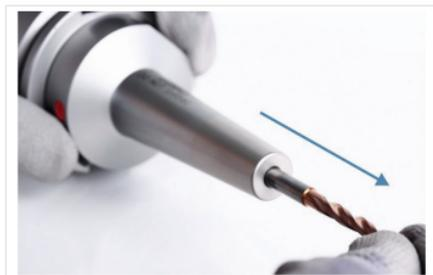
Abb. 13: Werkzeug entnehmen
