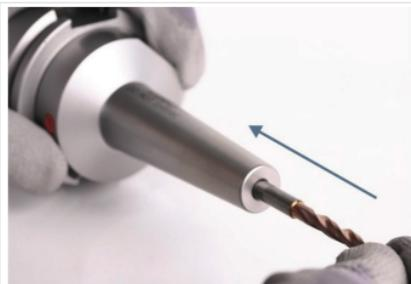
Abb. 9: Werkzeug einschieben
