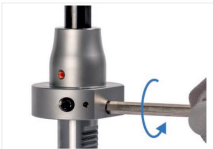
Abb. 18: Klemmschraube lösen
