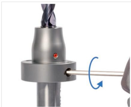
Abb. 12: Spannschrauben lösen
