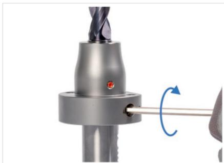
Abb. 11: Spannschraube 2 anziehen
