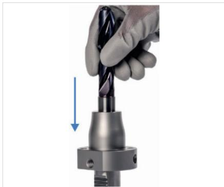
Abb. 10: Werkzeug einschieben
