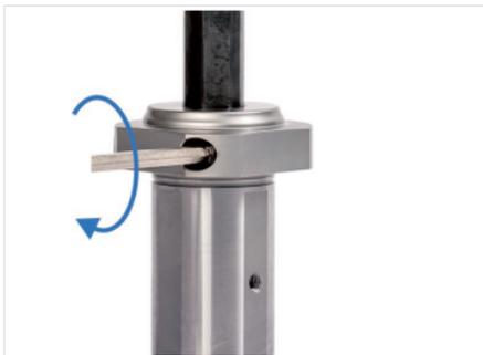
Abb. 21: Spannschraube anziehen
