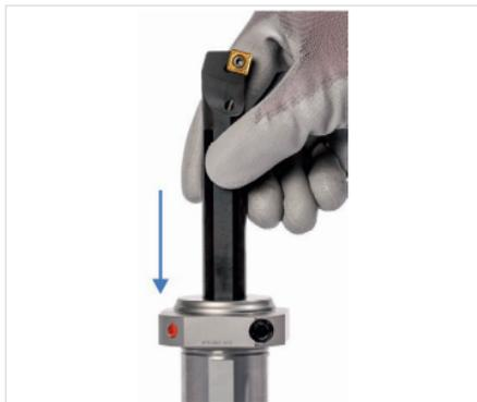
Abb. 19: Werkzeug einschieben
