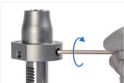
Abb. 9: Spannschraube 1 anziehen
