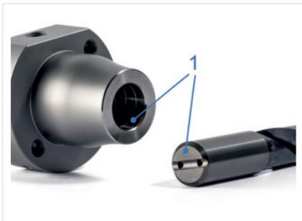
Abb. 7: Dehnspannfutter und Werkzeug reinigen
