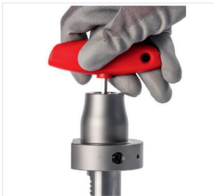
Abb. 8: Werkzeuglänge einstellen (axial)
