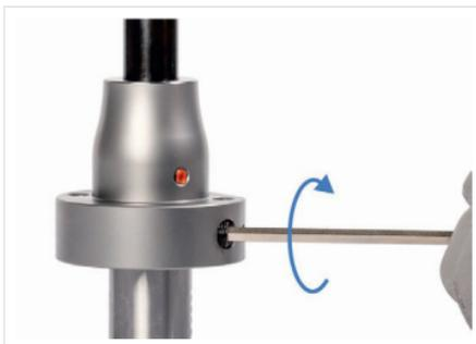
Abb. 16: Spannschraube 2 anziehen
