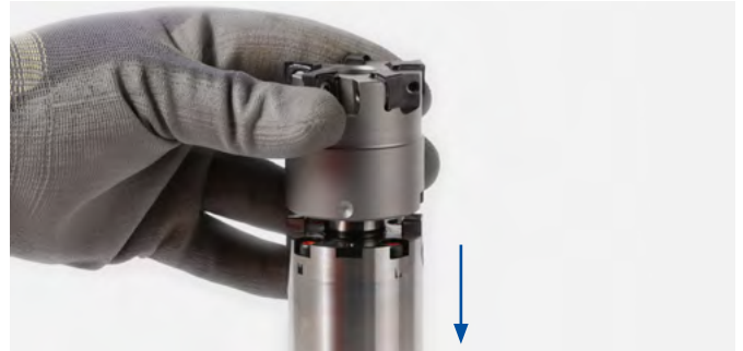
2. Den Fräseraufsteckdorn in eine Wechsellvorrichtung einspannen.
