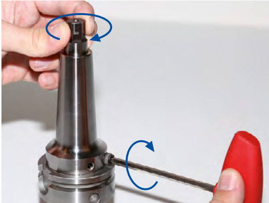
Abbildung 1: Spanschraube und Werkzeugprüfling drehen
