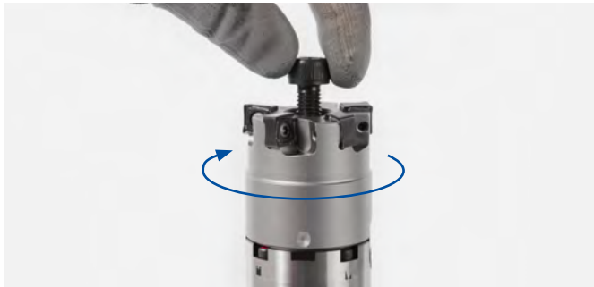
4. Die Fräseranzugsschraube in die Gewindebohrung des Fräseraufsteckdorns von Hand leicht eindrehen.
