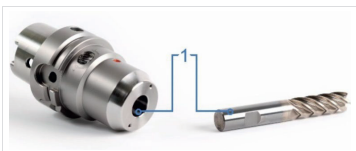
Abb. 6: HPH Spannfutter und Werkzeug reinigen
