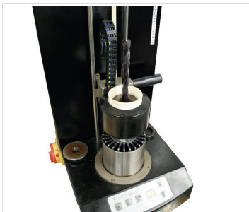
Abb. 10: Schrumpffutter mit Werkzeug erwärmen
