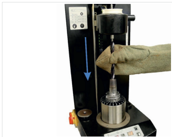
Abb. 8: Werkzeug in Aufnahmebohrung einführen
