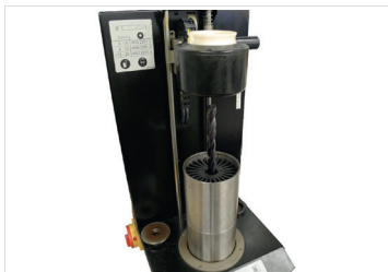
Abb. 9: Schrumpffutter mit Werkzeug abkühlen
