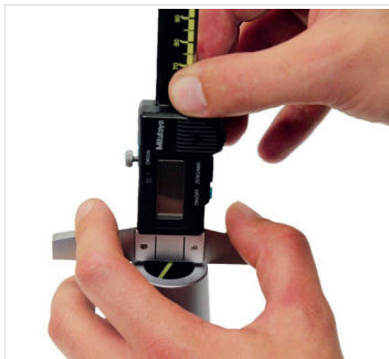
Abb. 6: Schrumpffutter auf Werkzeuglänge einstellen
