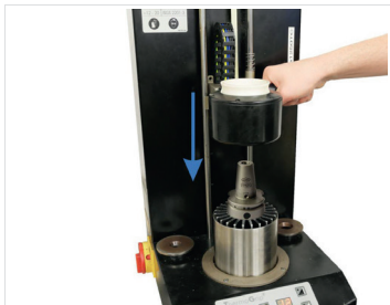
Abb. 7: Schrumpffutter mit Schrumpfgerät erwärmen
